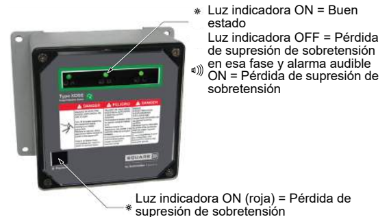
Figura 13: Diagnóstico de funcionamiento
